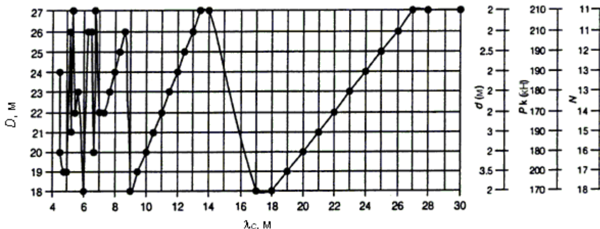
Рисунок Е.18 — Параметры, определяющие критический универсальный поезд в модели HSLM-A как функцию критической длины волны возбуждения \lambda_c , м
