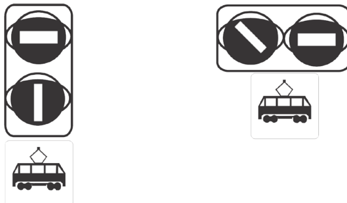
Рисунок Ж.3 – Обозначающие таблички ОТ.3 со светофорами Т.9.1, Т.9.гЗ
