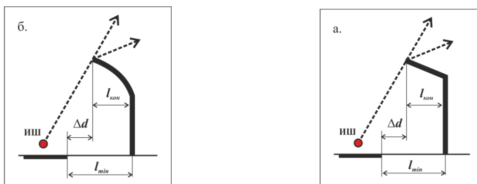
Рисунок 6.13 - Уменьшение расстояние между источником шума и экраном на величину \Delta d в случае коленообразных (а) и криволинейных(в) экранов
