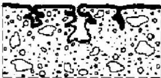
Рисунок 11 – Схема защиты бетона пропиткой
