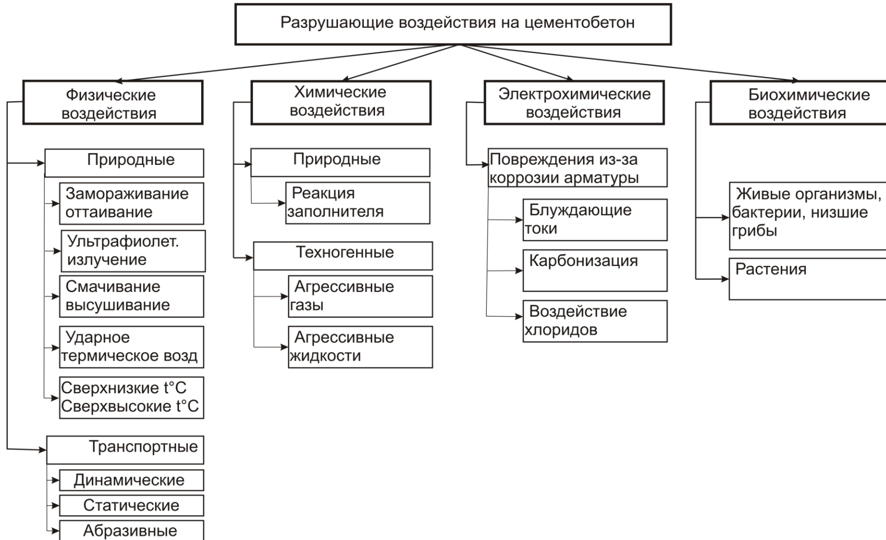
Рисунок 1 – Разрушающие воздействия на цементобетонное покрытие
