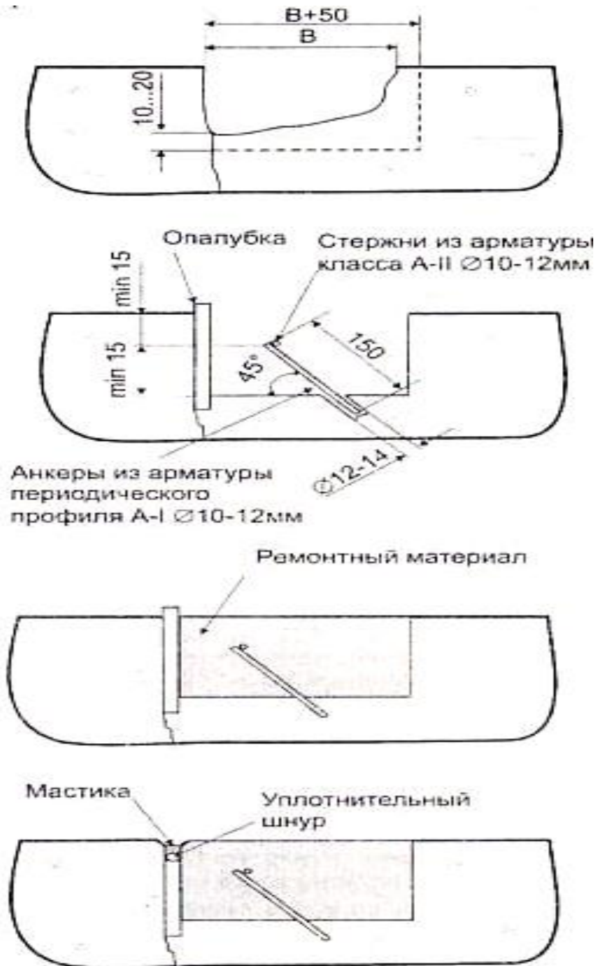
Рис.3.2. Ремонт плит со сколотыми кромками
