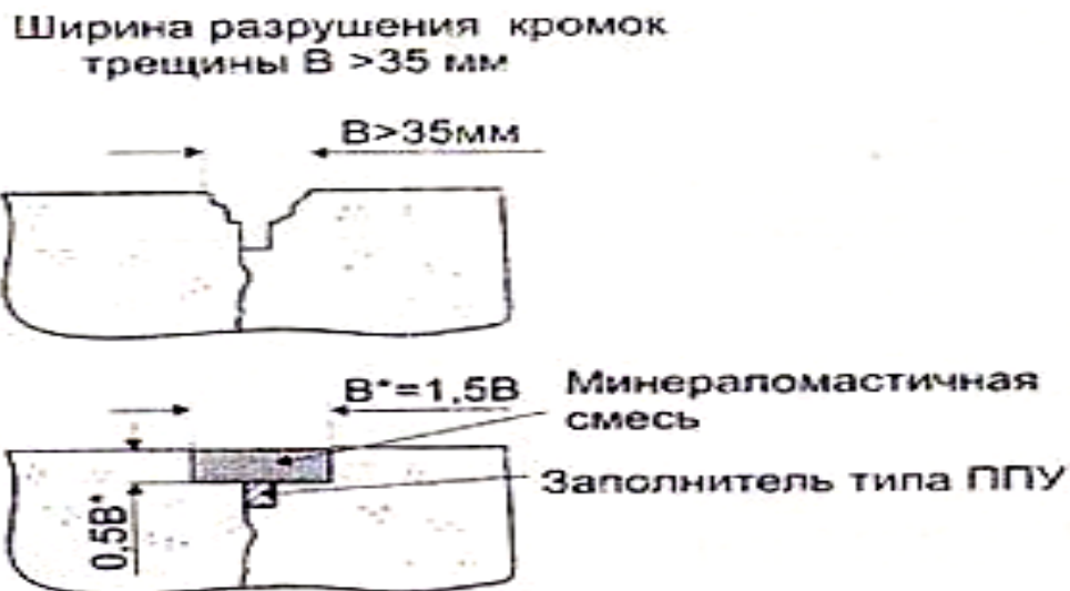
Рис.3.1. Герметизация швов с разрушением кромок шириной более 35мм.
