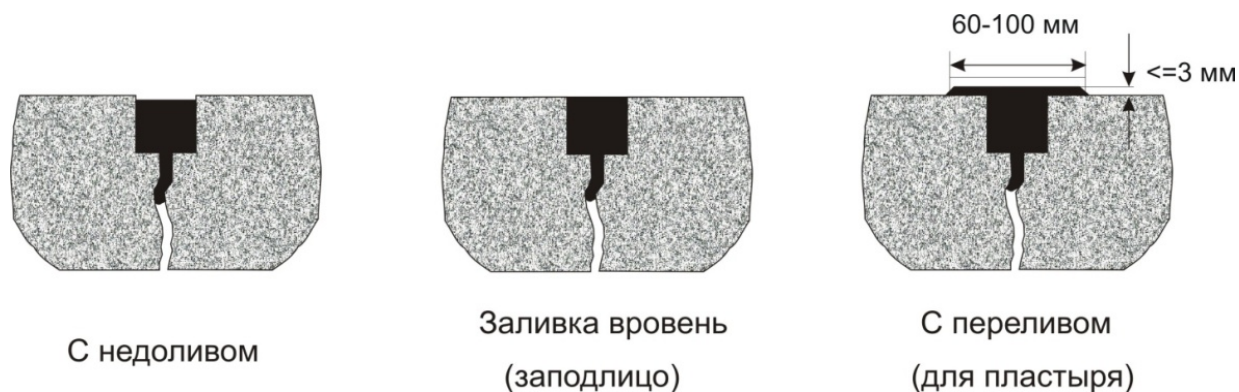
Рисунок 1 – Варианты заливки герметика в трещины
